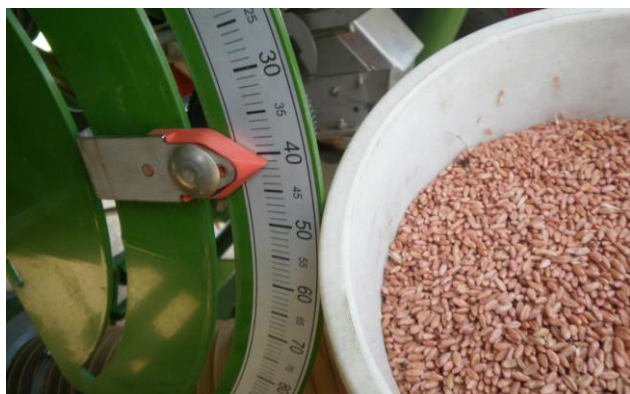
Рисунок 1 - Настройка сеялки ДМС - 6 на высев яровой пшеницы, 2025 г.
